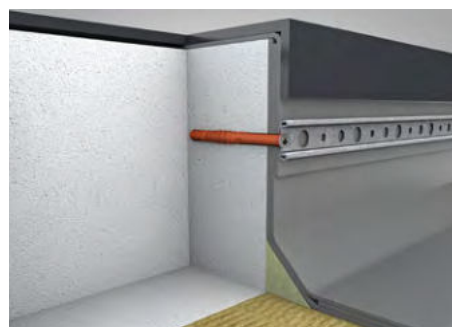
Umożliwia mocowanie membran dachowych w obszarach krawędziowych oraz w obszarach attyki.
